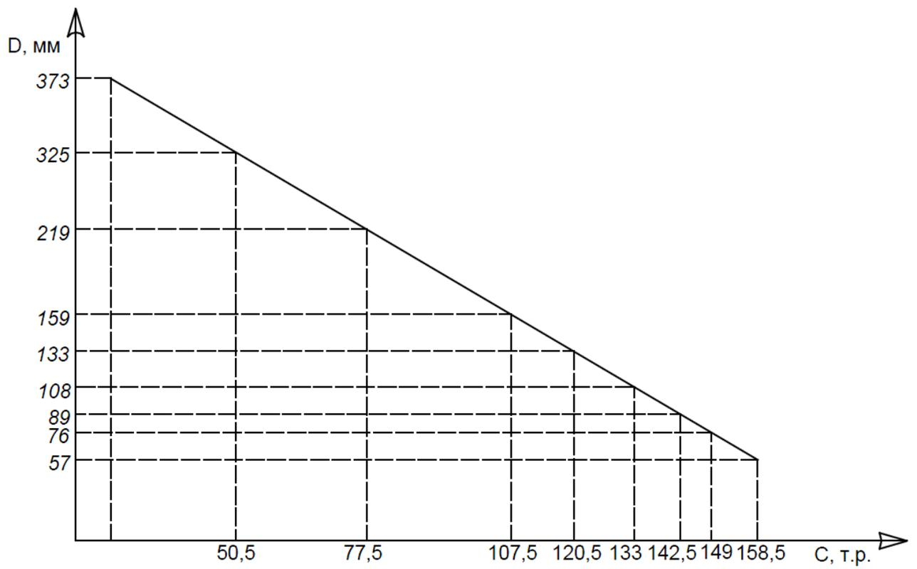
Рисунок 7.7 – Зависимость стоимости одного  $m^2$  материальной характеристики от диаметра трубопровода
